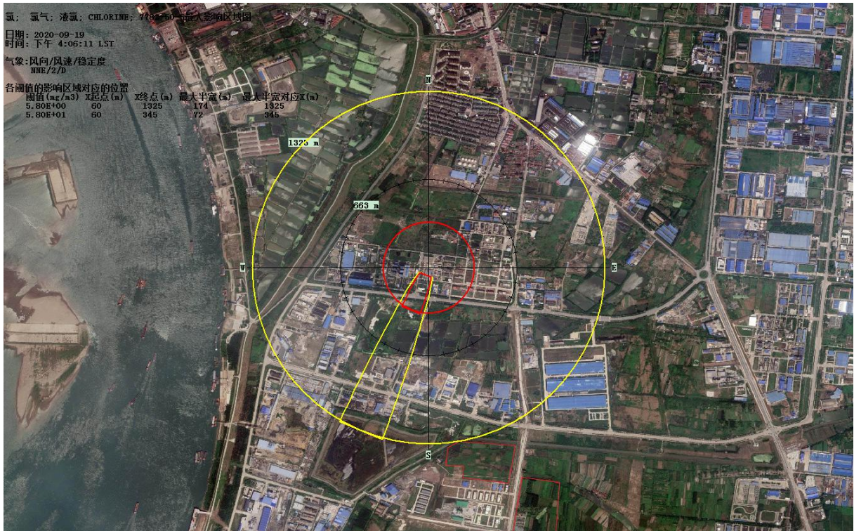
图 7-4 最常见气象条件氯气泄漏事故超过阈值最大轮廓
