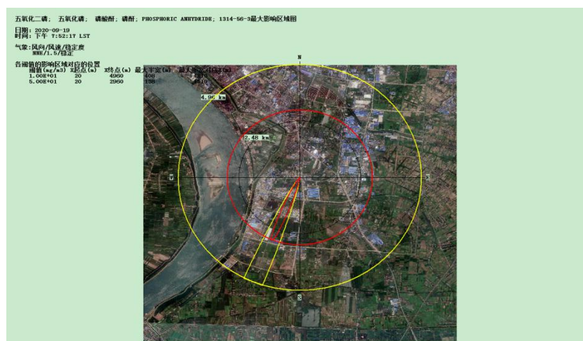
图 7-17 黄磷储罐火灾伴生/次生事故最不利气象预测结果
