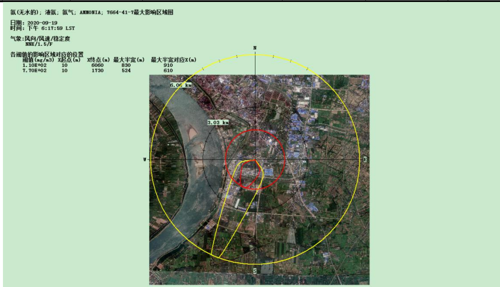
图 7-6 最不利气象条件氨气泄漏事故超过阈值最大轮廓
