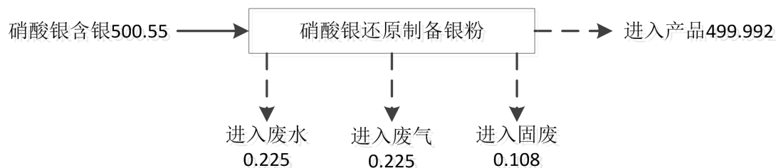
图 3-1 超细银粉生产线银元素平衡图 单位: kg/批
