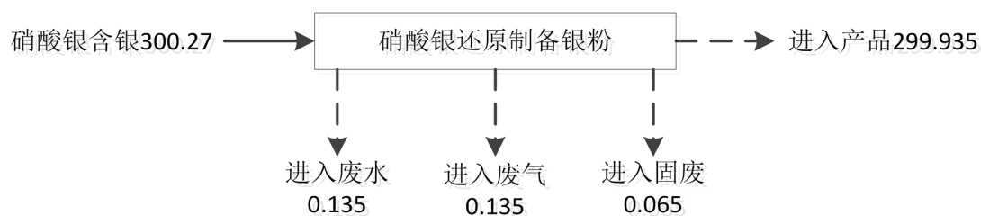
图 3-1 超细银粉生产线银元素平衡图 单位: kg/批
