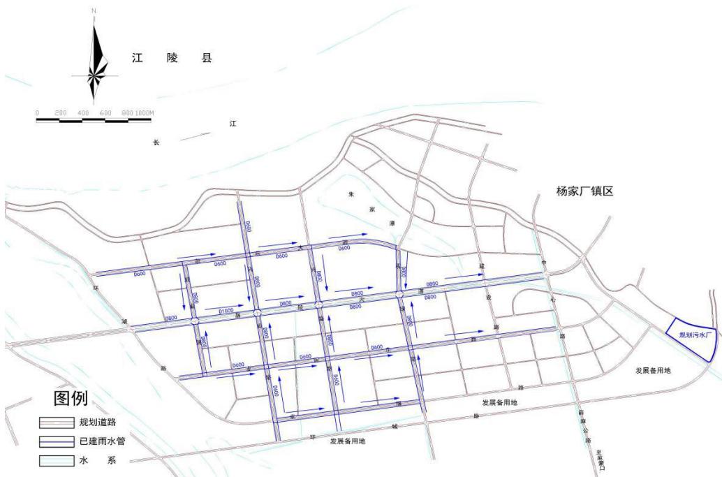
图 1.6-2 青吉工业园现有雨水管网示意图
