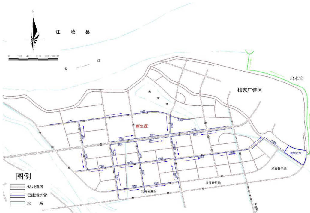
图 1.6-1 青吉工业园现有污水管网示意图
